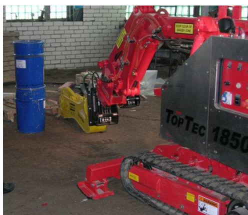
Рисунок 2 – Дистанционно-управляемая электрогидравлическая машина Top Tec
