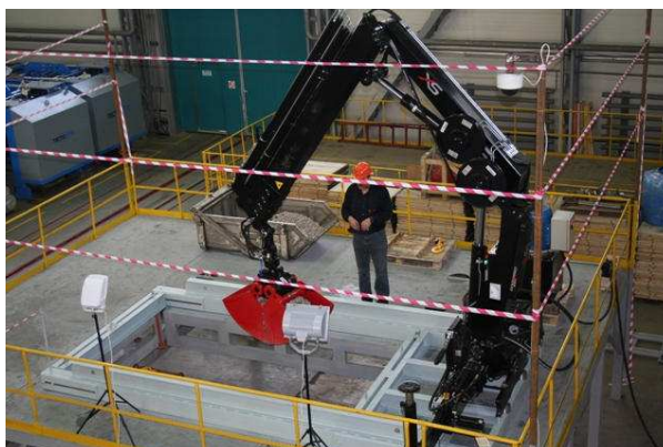
Рисунок 9 – Стенд-имитатор для проведения «холодных» испытаний
