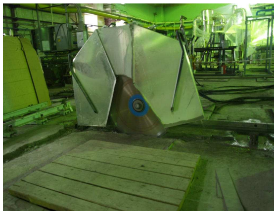
Рисунок 1 – Вырезка плиты перекрытия с применением алмазной дисковой пилы
