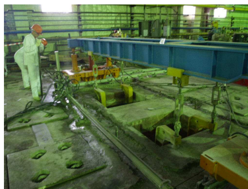
Рисунок 8 – Комплект оборудования для извлечения ТРО
